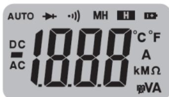
•) Режим проверки на обрыв (с зуммером)
