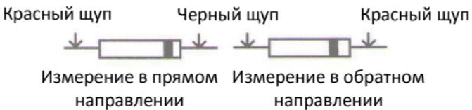
Если в режиме проверки на обрыв сопротивление цепи составляет менее 50Ом, срабатывает звуковой сигнал.
