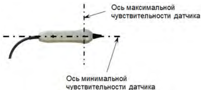
Рисунок А.2. Оси чувствительности датчика MED-127.
