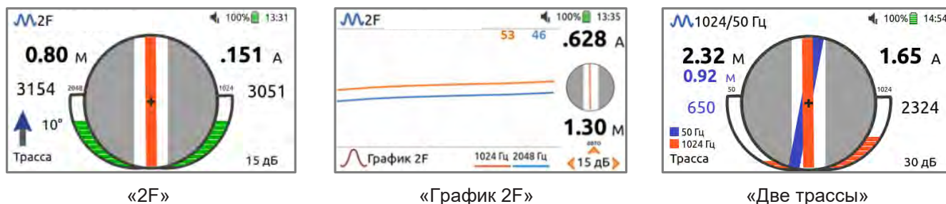
Рисунок 3.2. Виды индикации в двухчастотных режимах.
