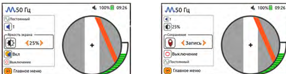
Рисунок 4.3. «Быстрое меню» приемников АП-019.4 и АП-019.5.
