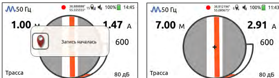
Рисунок 5.5. Вид экрана в режиме «Сохранение/Запись».
