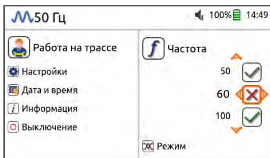
Рисунок 4.7. Установка набора частот и режимов в разделе меню «Частота».
