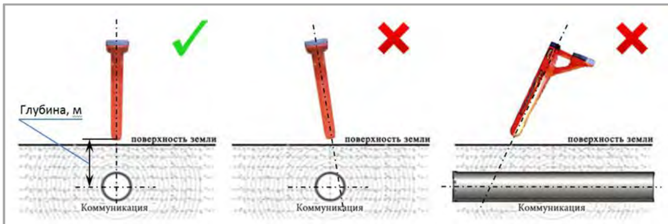
Рисунок 3.6. Правильное положение приемника при замере глубины.
