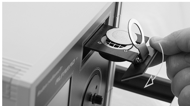
Рисунок 4д. Внешний вид БУ (Замена фильтра)
