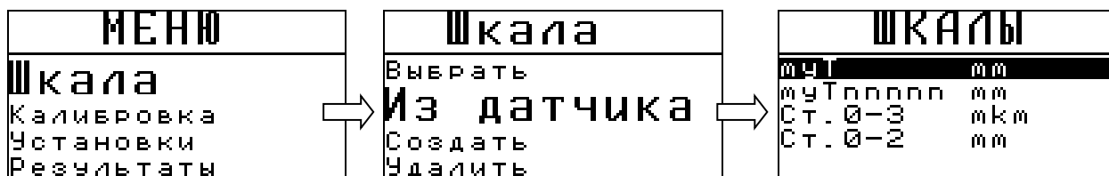
Рис.2-5 Виды экрана при загрузке шкалы из памяти преобразователя
