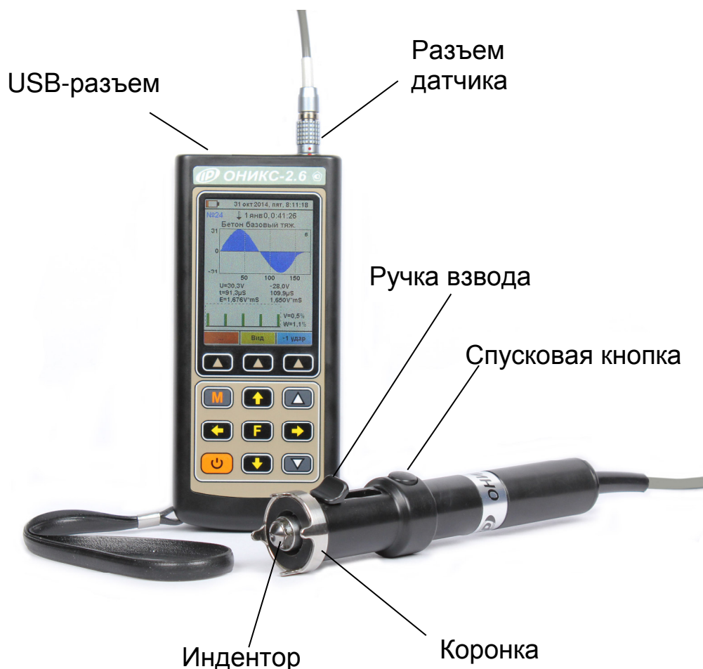
Рис. 3.1. Внешний вид прибора модификации «Оникс-2.6»
