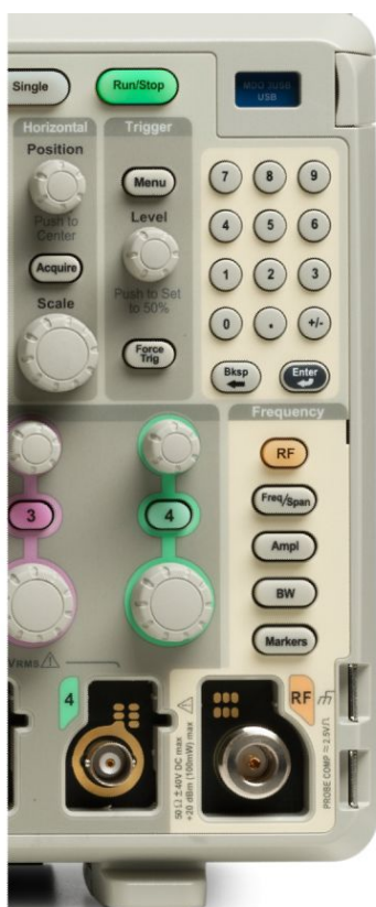
Основные параметры спектра быстро настраиваются с помощью специальных меню на передней панели и клавиатуры.
