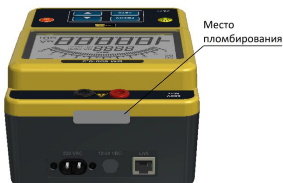
Рисунок 3 – Схема пломбировки от несанкционированного доступа
