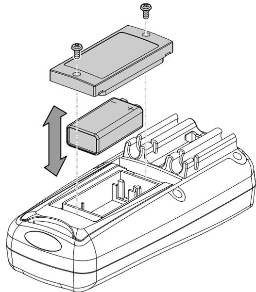
4. Закройте отсек для батарейки и закрутите винты.
