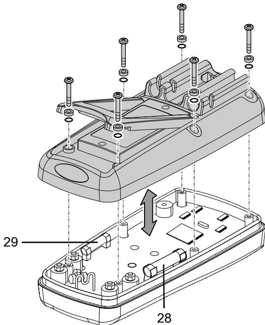
3. Установите крышку и зафиксируйте ее, затянув винты.
