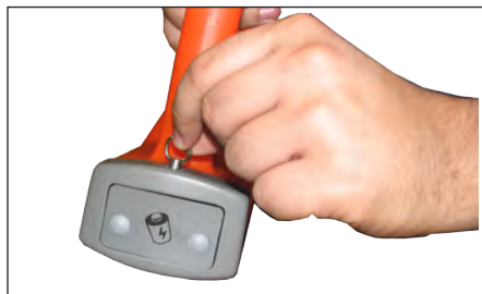
а) Выдвинуть фиксатор и освободить батарейный отсек
